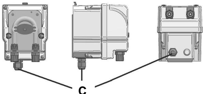
**I** Il cavo elettrico di alimentazione della pompa è quello che esce dal pressacavo C in figura .
