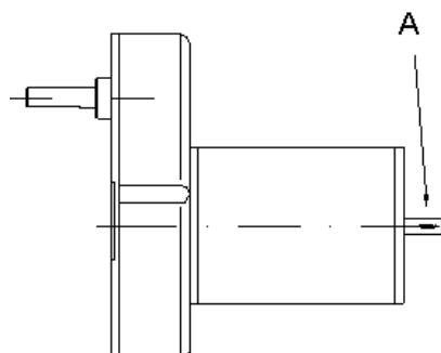
**I Modello in corrente continua:** Collegarsi ai contatti del moto-riduttore (A).
