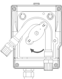
**I** Rimuovere il coperchio trasparente svitando le due viti sul frontale. Togliere il vecchio tubo sbloccando prima il raccordo di sinistra, girando nel senso della freccia il portarullino in modo da liberare il tubo fino al raccordo di destra.
