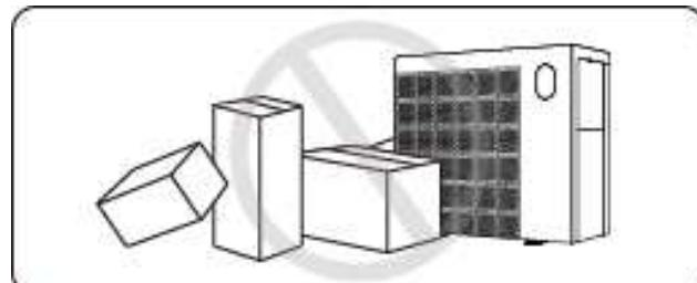
1.4.4. Plaats niets in de inlaat of uitlaat van de warmtepomp, of het rendement van de warmtepomp zal worden verminderd of zelfs stop gezet worden.
