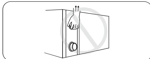
1.4.3. Zet geen objecten voor de luchttoevoer en –afvoer van de warmtepomp.
