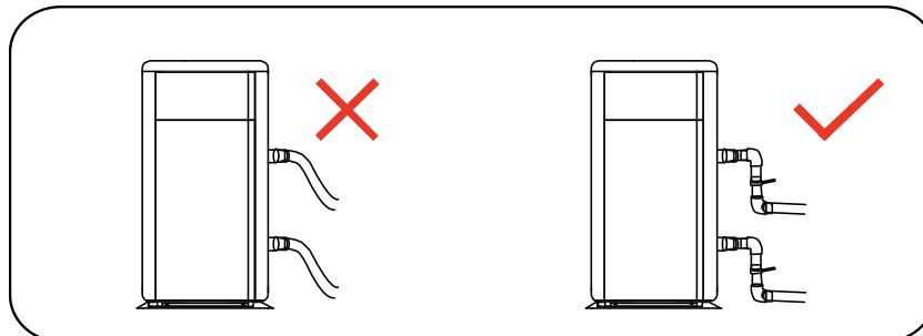
2.1.2. Afin de garantir l'efficacité du chauffage, la longueur du tuyau d'eau doit être  $\leq 10\text{m}$  entre la piscine et la pompe à chaleur.
