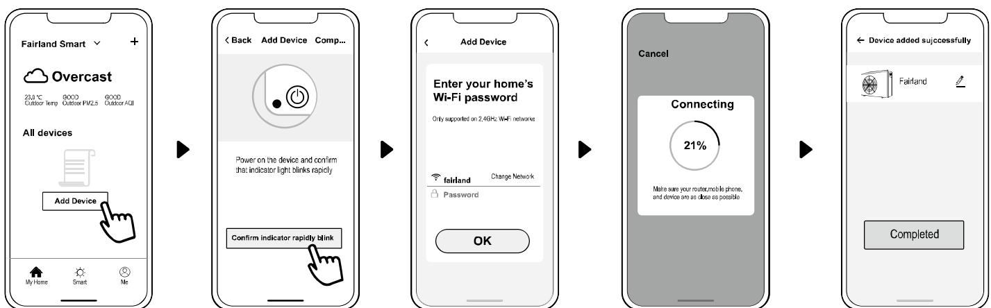
c) Als de verbinding mislukt, zorg er dan voor dat uw netwerknaam en wachtwoord juist zijn en uw router, mobiele telefoon en apparaat zo dicht mogelijk bij elkaar zijn.
